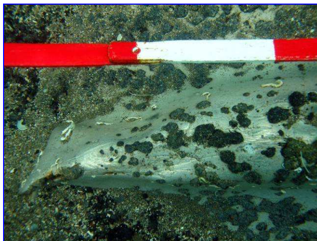
Détail du bloc d'aluminium présentant des rayures profondes et des bosses
